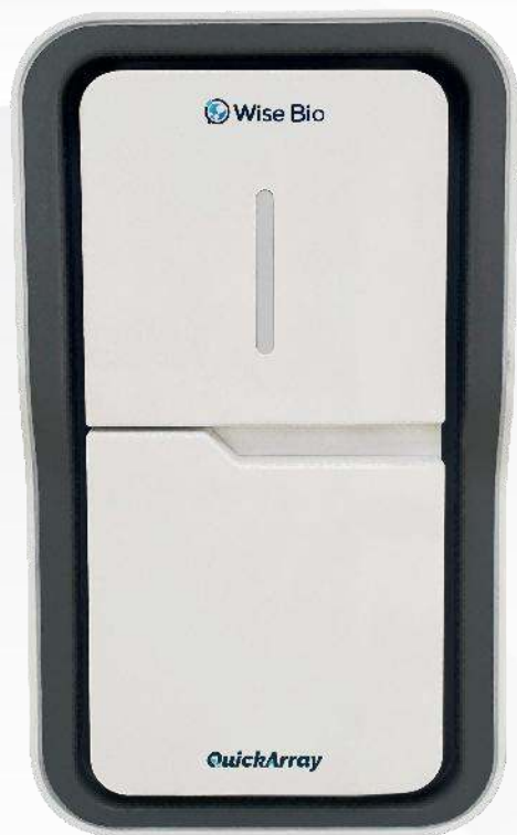
多重核酸检测平台，单次加样可检测52重核酸
